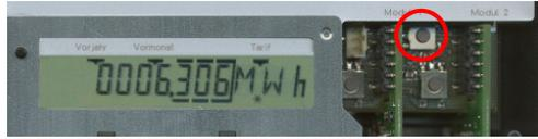
Servicetaste für ca. 3 s betätigen. Auf der LCD erscheint die Anzeige PRUEF----.
