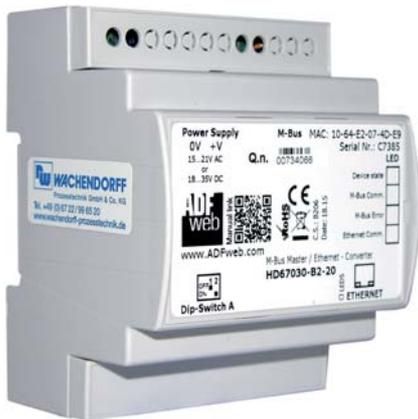
Der Pegelwandler HD67030-B2 ermöglicht die Kommunikation zwischen bis zu 80 M-Bus-Teilnehmern und ethernetbasierenden Geräten. Er setzt hierbei die M-Bus-Physik auf Ethernet um. Die Protokolleigenschaften werden nicht beeinflusst. Er ist mit der zugehörigen PC-Software über die Ethernet-Schnittstelle einfach zu konfigurieren. Die Montage erfolgt einfach und zuverlässig auf einer DIN-Hutschiene.
