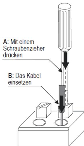
**Herausziehen eines starren Kabels**
