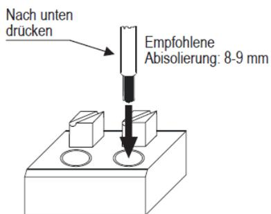
**Einsetzen eines dünnen Kabels**
