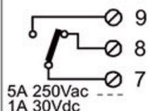
Relaiskontakte können mit einer maximalen Last von 5 A @ 250 VAC oder 1 A @ 30 VDC betrieben werden. Um induktive Lasten betreiben zu können, ist es erforderlich Filter einzusetzen. Hierbei werden zusätzlich Spannungsspitzen die bei Ein- und Ausschaltvorgängen auftreten ausgefiltert. Dies kann die Lebenszeit des Relais verlängern.
