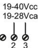
Die Spannungsversorgung muss in einem Bereich von 19 bis 40 VDC liegen (Polarität gleichgültig), von 19 bis 28 Vac; siehe auch Abschnitt INSTALLATION. Die oberen Grenzen dürfen nicht überschritten werden. Eine Überschreitung kann zu Beschädigungen des Moduls führen. Es ist erforderlich die Spannungsversorgung mit einer korrekt dimensionierten Sicherung zu schützen.
