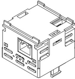
Ethernet-Schnittstellenmodul für das Basisgerät PM-50
