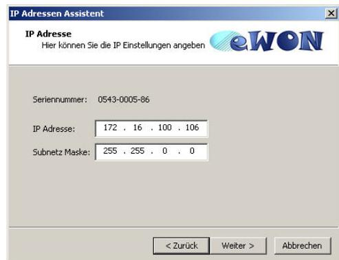
Das Ändern der IP-Adresse wird nun ausgeführt. Am Ende können Sie das Fenster mit **Fertig stellen** schließen.
