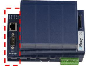
Dort können direkt Endgeräte innerhalb der Maschine bzw. des zu erreichenden Netzwerkes angeschlossen werden.
