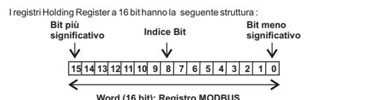
La notazione Bit [x:y] riportata in tabella indica tutti i bit dal x a y. Ad esempio Bit [2:1] indica il bit 2 e il bit 1, e serve ad illustrare il significato delle varie combinazioni congiunte di valori dei due bit. Da ricordare che sui seguenti registri possono essere eseguite le funzioni MODBUS 3, 4, 6 e 16, di lettura e scrittura singola e multipla.
