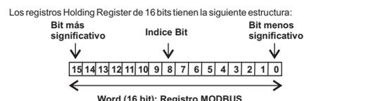
La notación Bit [x:y] reproducida en la tabla indica todos los bit del x a y. Por ejemplo, Bit [2:1] indica el bit 2 y el bit 1, sirve para ilustrar el significado de las varias combinaciones conjuntas de valores de dos bit. Cabe recordar que en los siguientes registros se pueden realizar las funciones MODBUS 3, 4, 6 y 16, de lectura y escritura individual y múltiple.
