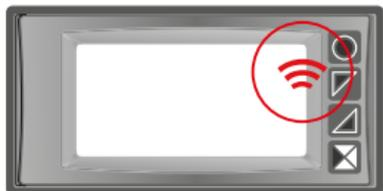
Position der NFC/ RFID Antenne für die Kommunikation mit dem Smartphone und Lesen und Schreiben von Daten
