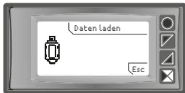
Bei "Daten laden" wird die Konfigurationsdatei von der Speicherkarte geladen. Bei "Esc" wird der Vorgang abgebrochen, ohne dass eine Änderungen an der aktuellen Konfiguration erfolgt.
