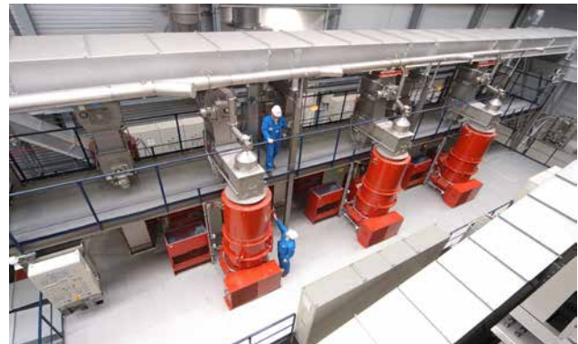
WP1803_07 Amandus Kahl Flachmatrizenpresse Ersatzbrennstoffe Pellets Fluff.
