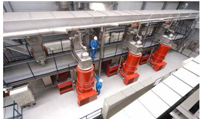
WP1802_8 Amandus Kahl Flachmatrizenpresse Ersatzbrennstoffe Pellets Fluff.
