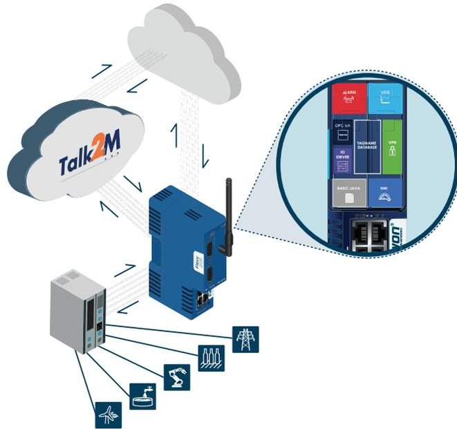
**Abbildung 4-4:** Der Ewon Flexy verbindet entfernte Feldgeräte mit Hilfe verschiedener Kommunikationsprotokolle.
