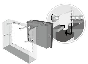
Kabel. Berücksichtigen Sie die Wärme von anderen Geräten im Inneren des Gehäuses. Die Umgebungstemperatur um das Gerät herum muss 0 bis 50°C betragen.
