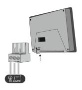
Spezifikationen des Netzsteckers: Kabel-Querschnitt: 0,0804 mm² bis 3,31 mm² Betriebstemperatur: -40 °C bis 105 °C Schraubendrehmoment: 15,44 N (max.)
