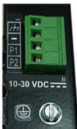
1. Installieren Sie eine 3,33 Ampere Sicherung am Eingang des Switchs.
